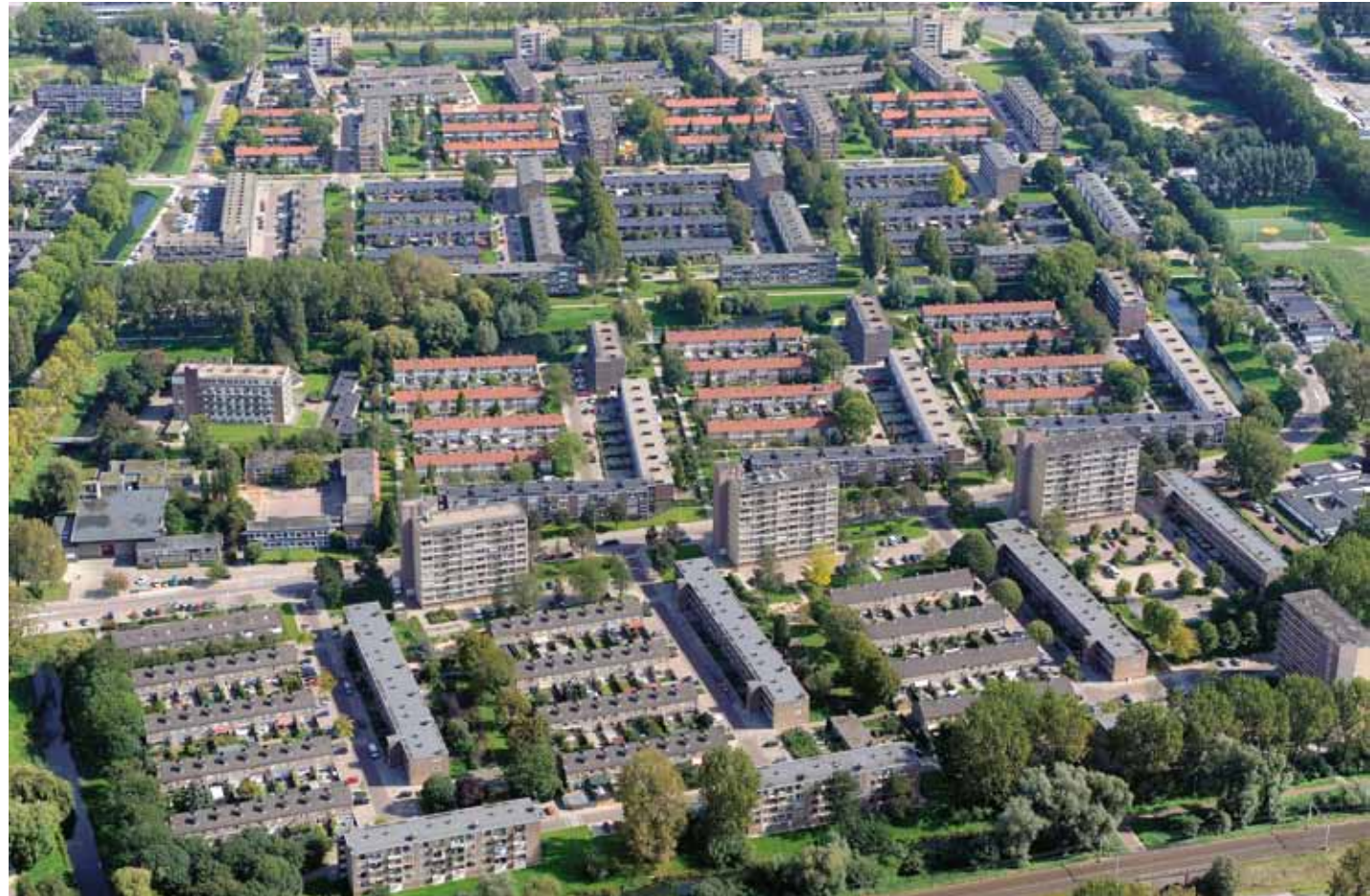
Groeperingen van verschillende typen woningen, die identiek herhaald worden. 'Stempelbouw' in Presikhaaf. De tuinstad in een modern jasje. (foto: De Gelderlander)
